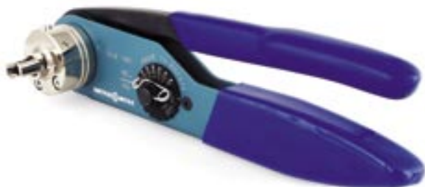
Crimpzange, mittel für kleine und mittlere Crimpungen – Ø 1 mm und Ø 2 mm Kontakte bis Aderquerschnitt 4 mm 2 inklusive Positionierer
